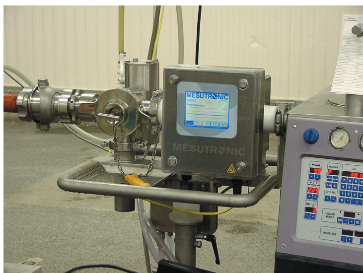
Elektroniczny Separator Metalu P-TRON 05 O TOUCH Instalacja na nadziewarce próżniowej.
